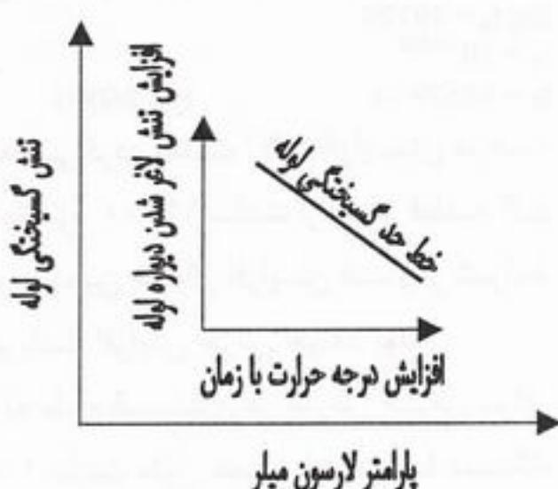
همانطور که در شکل فوق ملاحظه میشود شرایط کاری در طول عمر باقیمانده لوله بویلر اثر دارد. افزایش درجه حرارت، یا زمان و افزایش تنفس باعث میشود که لوله به خط گسیختگی نزدیک شود.
