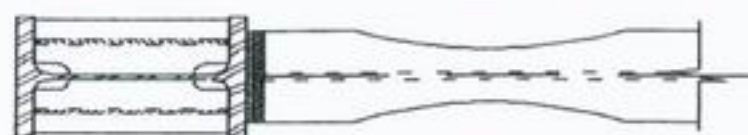
شکل (۷): نمای بالای اتصال RBS (بین تیر و ستون)
